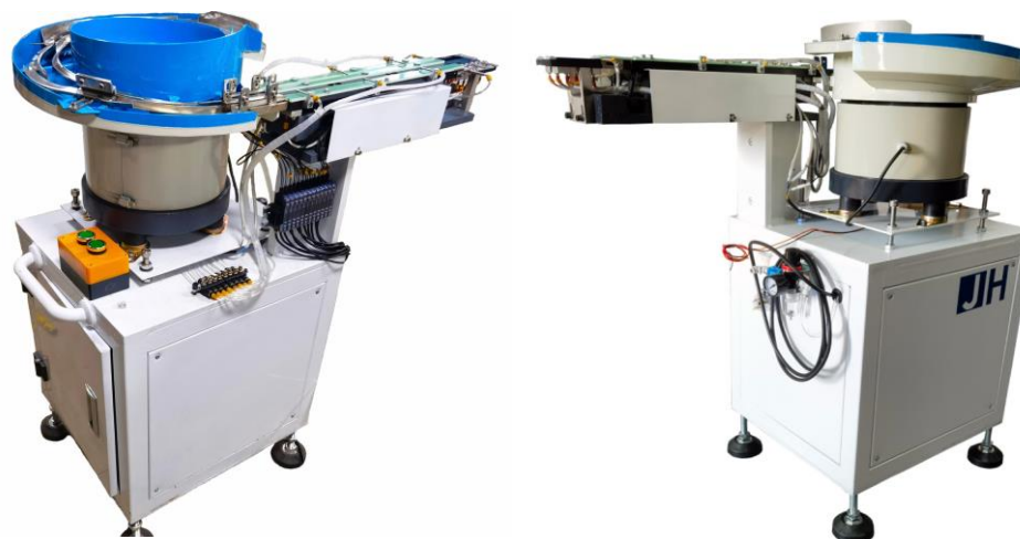
透镜全自动供料，机器升级改善只有2个开关
